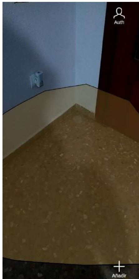
Figura 3.2.3 superficie amarilla representa la superficie detectada por el framework .
