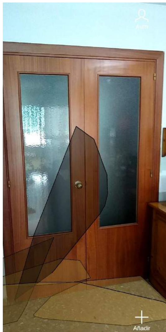
Figura 3.2.4 superficie de la puerta siendo detectada.
